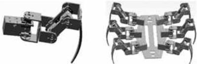
图2 爬行式机器人机械腿与整体装配图
