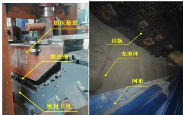
图6 密封卡具加压设计 图7 采空区充填效果
