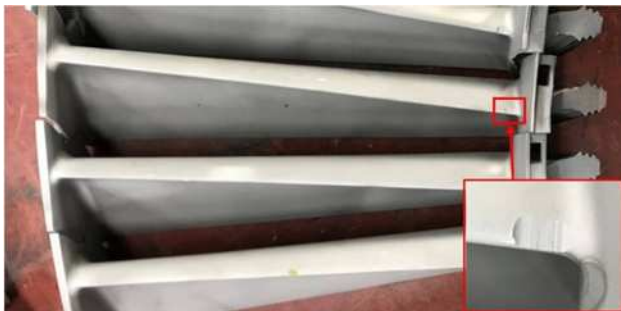
图2 低压涡轮2级转叶前缘根部磨损
