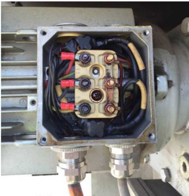
图 2 天线驱动马达的接线图
