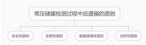
图1 常压储罐检测过程中应遵循的原则
