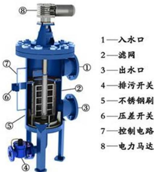
图1 过滤器构成
