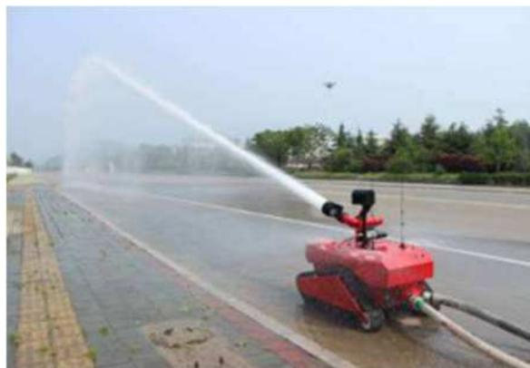
图 3 智能消防机器人的样机实验
