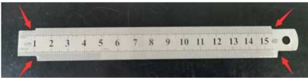
图 1 焊缝背面余高专用测量工具
