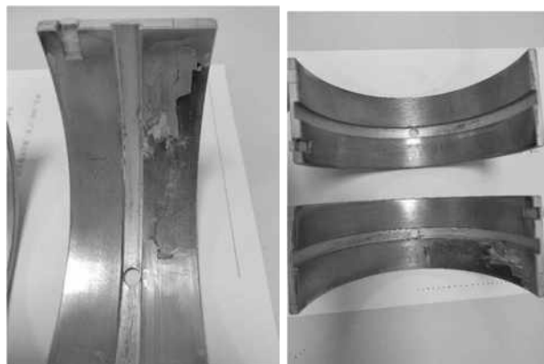
图 1 一级二列连杆大头瓦上瓦西侧中部脱落
