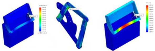
方案四计算结果应力图解
