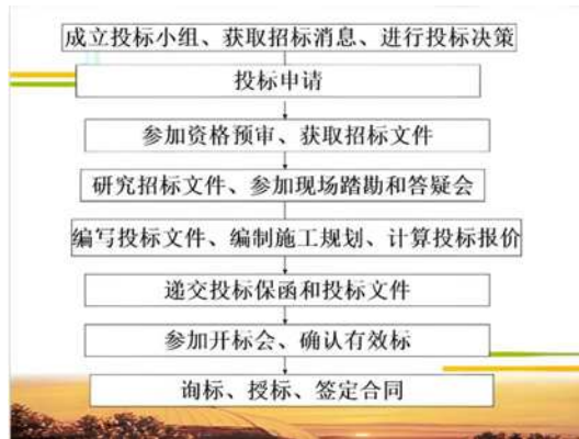
图1 水利水电工程招投标合同管理流程示意图
