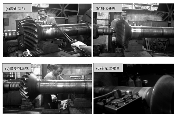
图3 磨损修复工艺设计及实施
