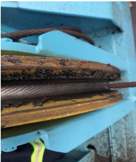
图5 较为典型的滑轮绳槽钢丝绳压痕
