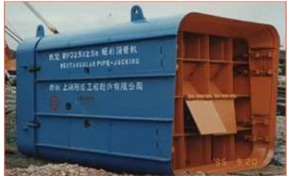
图3 2.5m\*2.5m 试验顶管机
