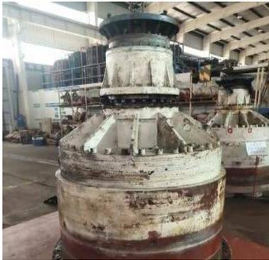
图 10 取出驱动系统总成
