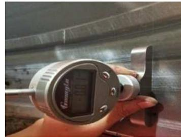
图 12 测量土砂密封摩擦面
