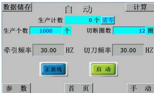
图1 预绞丝成型机触摸屏自动画面
