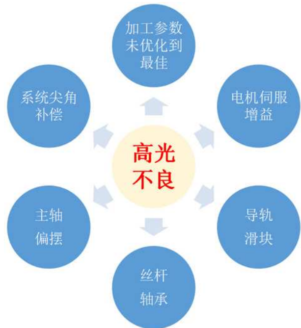
图 1 高光单边刀纹不良、拐角刀纹排除思路
