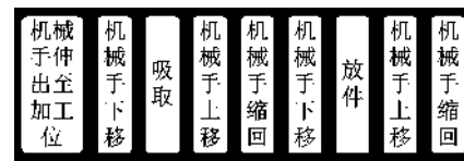
图 3 气动机械手正位放料工作流程
