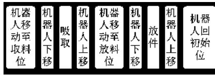
图 4 气动机械手正位放料工作流程
