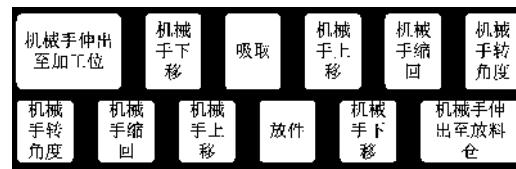
图 2 气动机械手侧位放料工作流程
