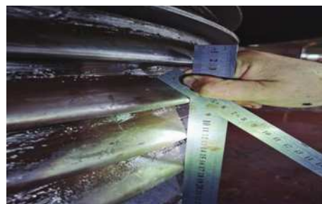
图1 定锥体螺纹磨损情况
