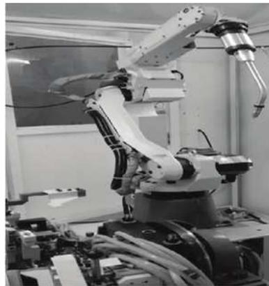
图1 激光焊型机器人
