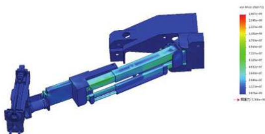
图5 施工帮锚杆应力分布图
