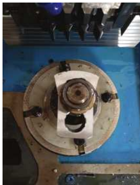
图5 齿扇在机床上加工
