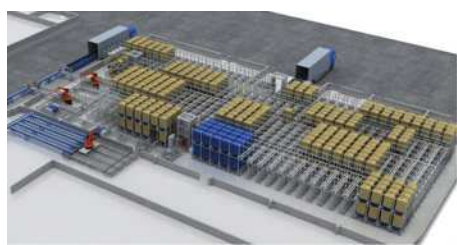
图3 穿梭车密集成品库工艺平面布局效果图
