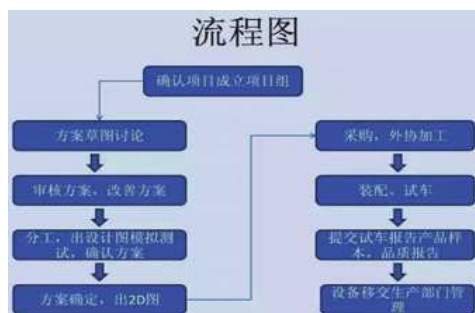
图1 自动化机械设备研发设计及制造流程图
