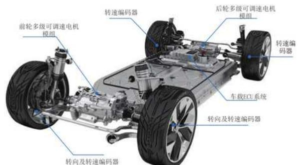
图2 装置结构组成设计
