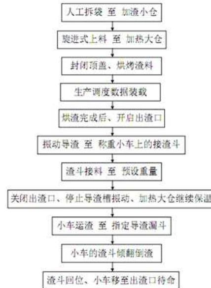
图3 电渣重熔渣料全自动烘烤装置工艺控制流程图
