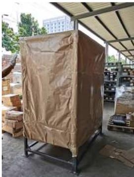
图3 防锈纸、干燥剂等放置包裹
