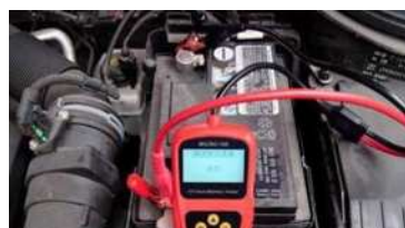
图2 利用仪表诊断线路故障
