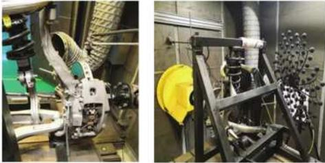
图11 制动器台架噪音测试
