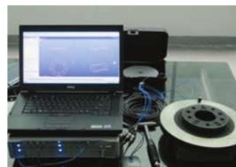
图3 制动盘模态试验
