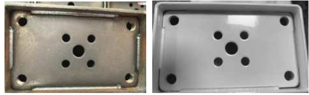
激光焊 喷塑前状态
