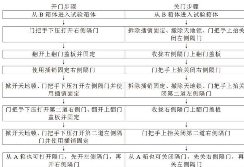
图3 开门、关门操作流程图
