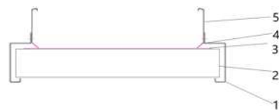
1. 机架; 2. 滚筒; 3. 输送带; 4. 护皮; 5. 挡板
