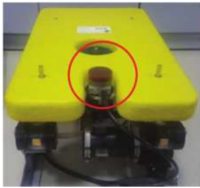
图1 Outland1000水下机器人(红圈内为声呐)
