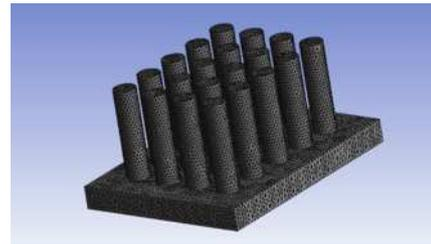
图8 散热器几何模型
