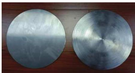
图四 使用薄片端面车削辅助装置前后工件车削对比图
