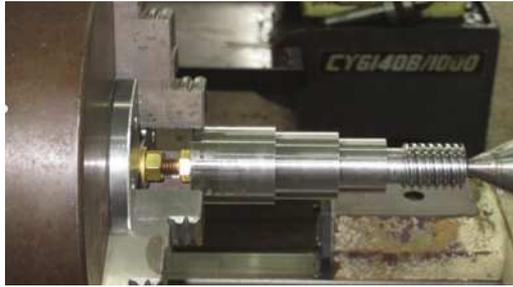
图五 装置当作轴类零部件的轴向定位装置使用图
