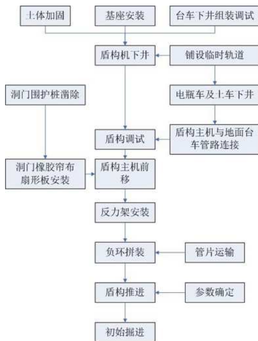
图1 盾构机组装与初始掘进施工流程图
