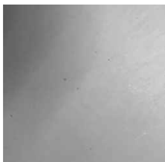
图1 循环罐使用3小时成品表面
