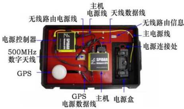
图 2 冰层雷达测厚仪结构图
