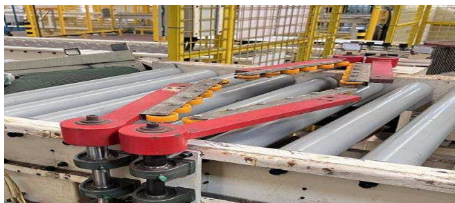
图 7 轮毂对中滚轮包胶及机械臂改机
