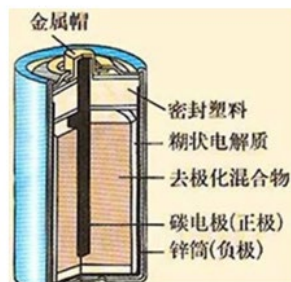
图 4 电池的剖面图
