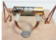
图 5 正在转动的简易线圈电机
