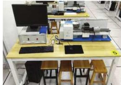
图1 微型数控车床
