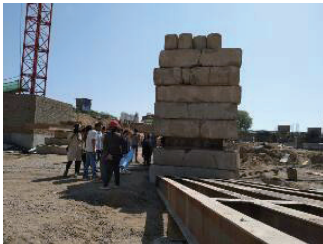
图3 静力载荷试验的现场实景教学
