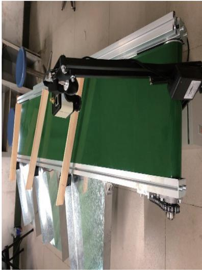
图3 分拣装置实物图
