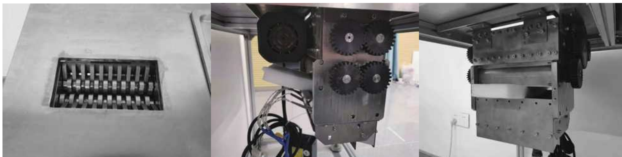
图 4：一体化厨余垃圾处理水盆柜样机
