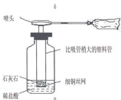
图一 实验室制取二氧化碳装置
