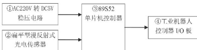
图 1 系统整体结构框图
