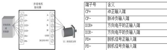
图1 步进电机驱动器原理图
