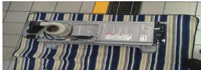
图 5 需更换的 HV 电池组
