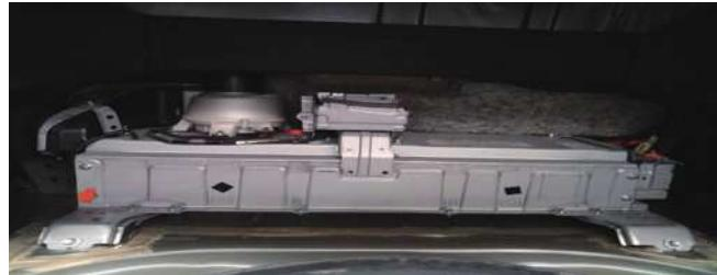
图 4 HV 蓄电池安装部位
