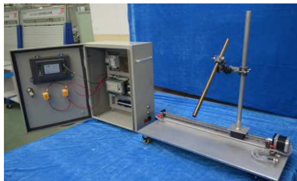
图4 多功能焊接工作台
