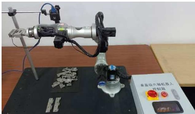
图1 机器人按需搬移工件系统
