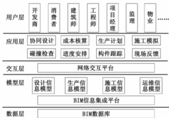
图 1 基于 BIM 技术的装配式建筑信息协同模型
